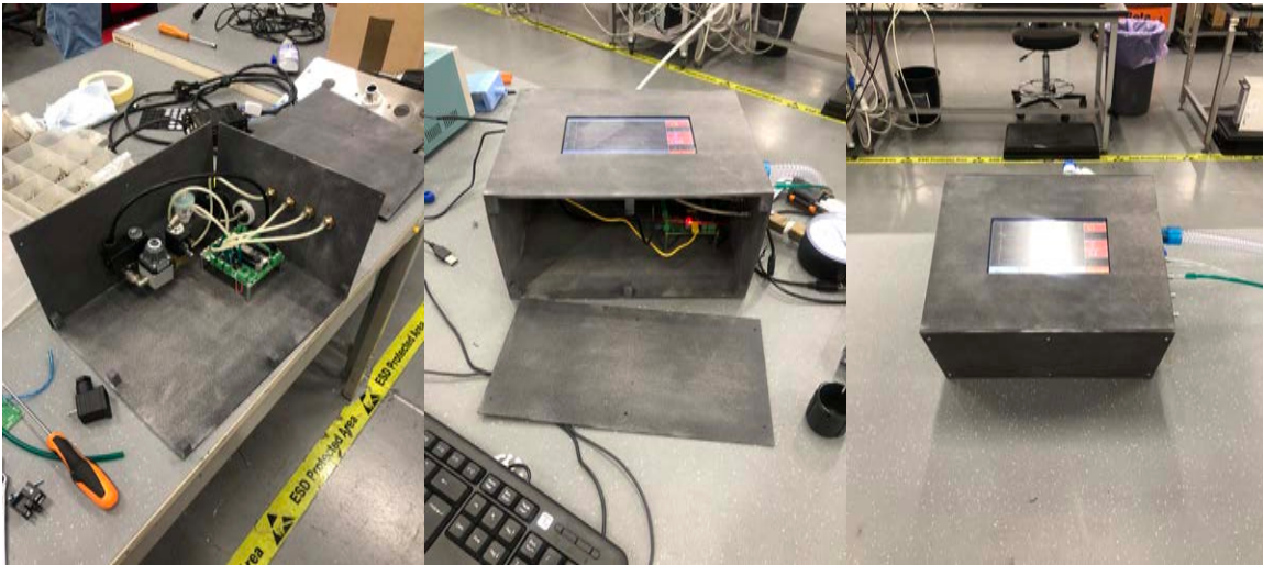
Figure 3 : la première unité de production en série de MVM, dans un boîtier temporaire en polymère imprimé en 3D, construit à Elemaster, dimanche de Pâques, le 12 avril 2020. De gauche à droite, l'intérieur de l'unité, l'unité en cours d'achèvement et l'unité achevée en fonctionnement.
